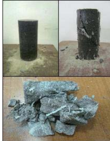
Gambar G.10. komposisi campuran 30LK:70ASP 0,1% serat. Distribusi serat cukup merata pada seluruh bagian benda uji.
