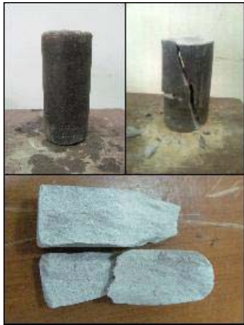
Gambar G.1. komposisi campuran 70LK:30ASP 0% serat. Benda uji setelah diuji langsung pecah..
