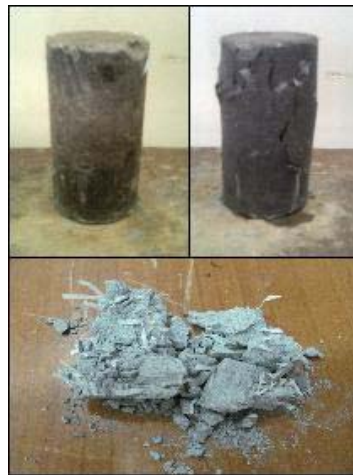
Gambar G.8. komposisi campuran 50LK:50ASP 0,3% serat. Distribusi serat tidak merata, kebanyakan menggumpal pada bagian ujung benda uji.
