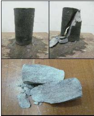
Gambar G.5. komposisi campuran 50LK:50ASP 0% serat. Benda uji setelah diuji langsung pecah..
