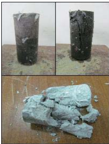
Gambar G.3. komposisi campuran 70LK:30ASP 0,2% serat. Distribusi serat tidak merata, kebanyakan menggumpal pada bagian ujung benda uji.
