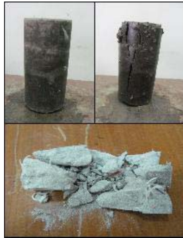
Gambar G.2. komposisi campuran 70LK:30ASP 0,1% serat. Distribusi serat tidak merata, kebanyakan menggumpal pada bagian ujung benda uji.
