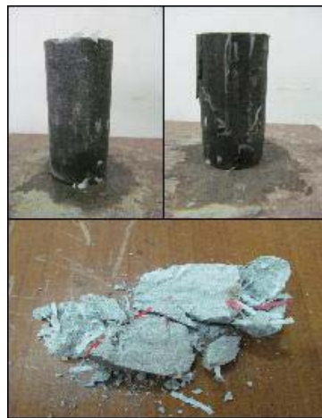
Gambar G.4. komposisi campuran 70LK:30ASP 0,3% serat. Distribusi serat tidak merata, kebanyakan menggumpal pada bagian ujung benda uji.
