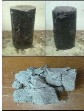
Gambar G.6. komposisi campuran 50LK:50ASP 0,1% serat. Distribusi serat tidak merata, kebanyakan serat berada pada bagian pinggir benda uji.
