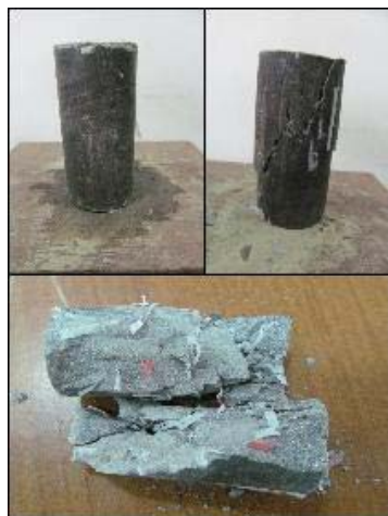
Gambar G.12. komposisi campuran 30LK:70ASP 0,3% serat. Distribusi serat cukup merata pada seluruh bagian benda uji.
