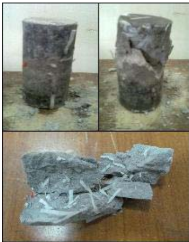
Gambar G.7. komposisi campuran 50LK:50ASP 0,2% serat. Distribusi serat cukup merata pada seluruh bagian benda uji.
