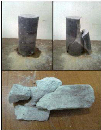
Gambar G.9. komposisi campuran 30LK:70ASP 0% serat. Benda uji setelah diuji langsung pecah..
