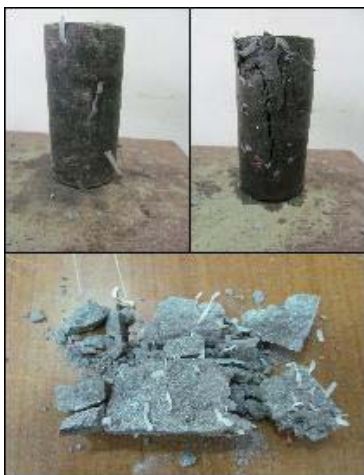
Gambar G.11. komposisi campuran 30LK:70ASP 0,2% serat. Distribusi tidak merata, serat menggumpal pada bagian bawah dan tengah benda uji.
