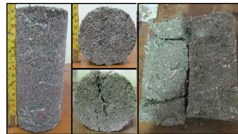
Gambar 5.8 benda uji diameter 90 mm campuran pasir, kapur, ASP, serat 0,1%
