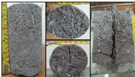
Gambar 5.7 benda uji diameter 70 mm campuran pasir, kapur, ASP, serat 0,1%
