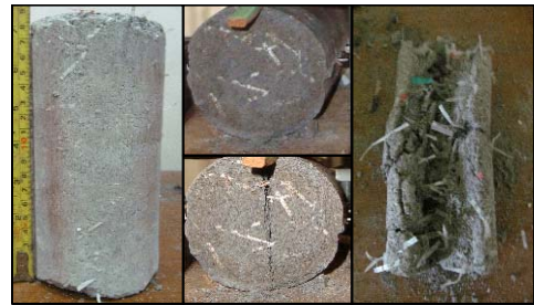
Gambar 5.12 benda uji diameter 90 mm campuran pasir, kapur, ASP, serat 0,2%
