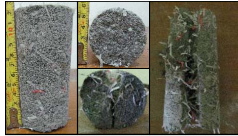
Gambar 5.10 benda uji diameter 60 mm campuran pasir, kapur, ASP, serat 0,2%
