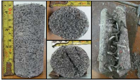
Gambar 5.9 benda uji diameter 50 mm campuran pasir, kapur, ASP, serat 0,2%
