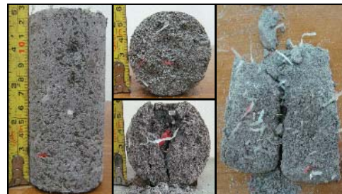
Gambar 5.6 benda uji diameter 60 mm campuran pasir, kapur, ASP, serat 0,1%
