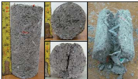
Gambar 5.5 benda uji diameter 50 mm campuran pasir, kapur, ASP, serat 0,1%
