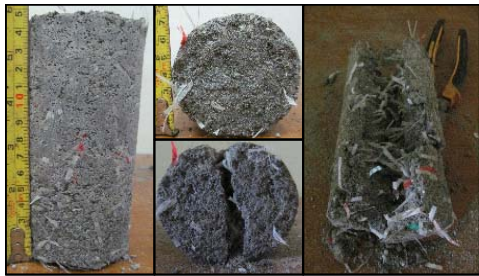
Gambar 5.11 benda uji diameter 70 mm campuran pasir, kapur, ASP, serat 0,2%
