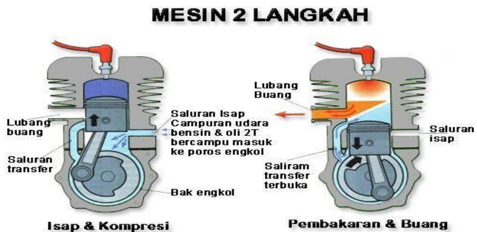
Gambar 2.7 Skema Motor Bensin 2 Langkah
