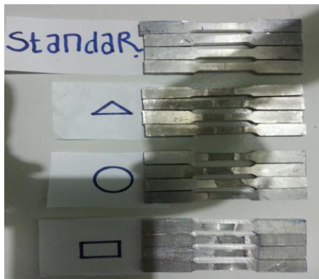
Gambar 7. Spesimen Uji standar ASTM E08 hasil pengelasan FSW Setelah hasil pengelasan FSW dibentuk menjadi specimen uji standar
