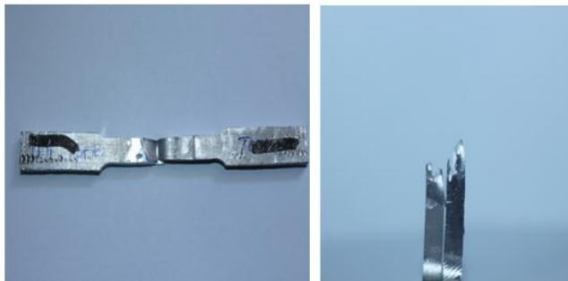
Gambar.18. Hasil patahan pin tool segi tiga
