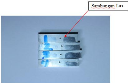
Gambar 8 spesimen yang digunakan pengujian struktur mikro
