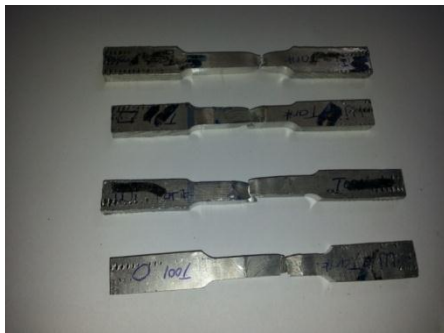
Gambar 14. Penampang patah spesimen uji setelah di uji tarik
