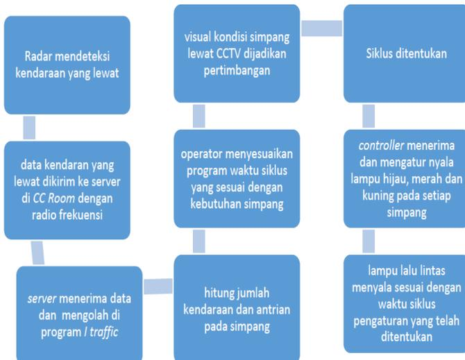
Gambar 1 proses kerja detektor adaptif
