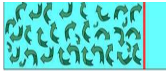
Gambar 2.4. Aliran turbulent di dalam pipa ( www.magleworld.wordpress.com )
