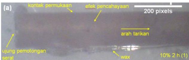
**Gambar 3.** Hasil Foto Mikro Spesimen Perendaman Serat 2 jam Konsentrasi Alkali 10%
