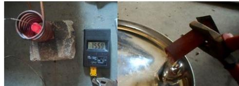
Gambar 15. Pengujian mesin dapur induksi.
