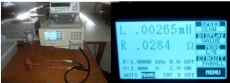
Gambar 3.9 Pengukuran kumparan kerja.
