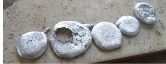
Gambar 14. Hasil pengujian dengan variasi masa benda aluminium (a) 5.31 gram waktu 3,22menit, (b) 6.99 gram waktu 3,30 menit, (c) 8.46 gram waktu 3,47menit, (d) 9.43 gram waktu 3,50, (e) 11.61 gram waktu 4,15menit.
