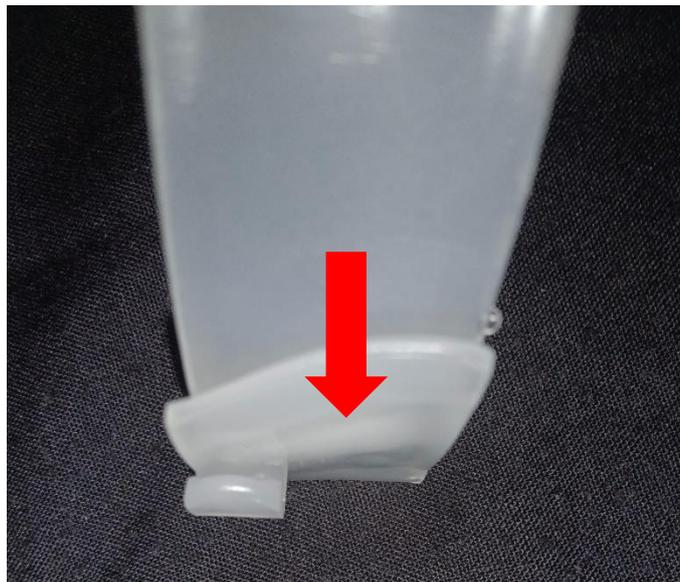
Gambar 1.1 Cacat sink mark pada frame faceshield
