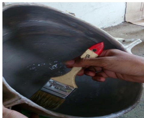
Gambar 4.9 Proses pelapisan sebelum diberi serat gelas
