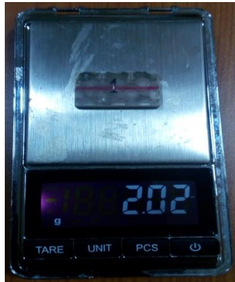
Gambar 3.11 Proses menimbang spesimen uji
