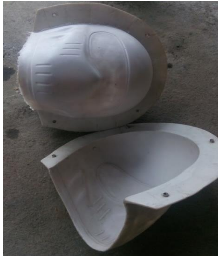
Gambar 4.12 Cetakan bagian depan yang sudah terlepas
