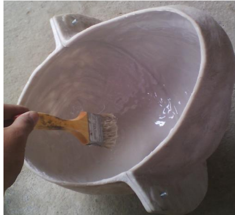
Gambar 4.7 Cetakan yang sudah disatukan
