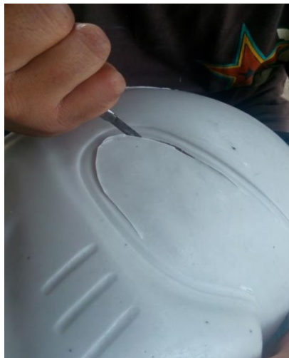
Gambar 4.13 Proses membuat lubang pengelihatan pada helm
