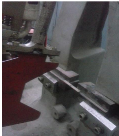
Gambar 3.10 posisi pendulum sebelum menabrak benda uji
