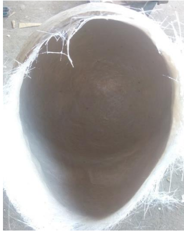
Gambar 4.11 Serat acak yang sudah dilapisi dengan resin
