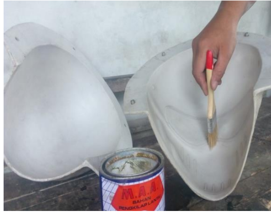
Gambar 4.2 Pemberian lapisan MAA pada molding
