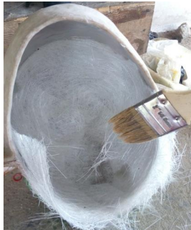
Gambar 4.10 Proses penyusunan serat acak kedalam cetakan
