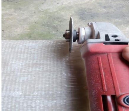
Gambar 3.4 proses pemotongan bagian yang tidak diperlukan
