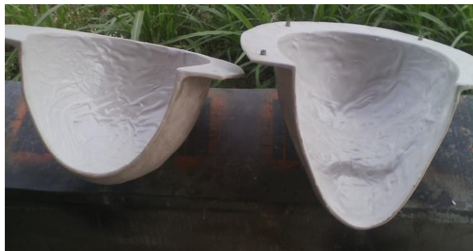
Gambar 4.6 Cetakan yang sudah diberi lapisan pertama
