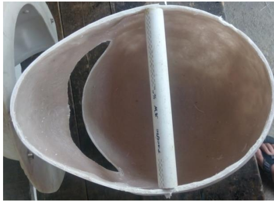
Gambar 4.14 Posisi pemasangan pipa penyangga ukuran helm
