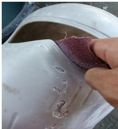
Gambar 4.17 Void yang terdapat pada permukaan helm
