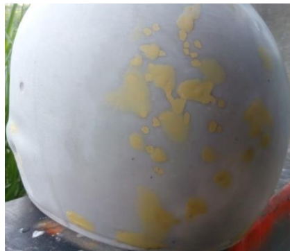
Gambar 4.19 Permukaan dempul yang sudah diampelas
