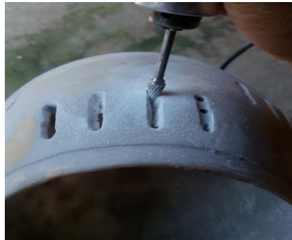
Gambar 4.20 Proses pembuatan lubang sirkulasi
