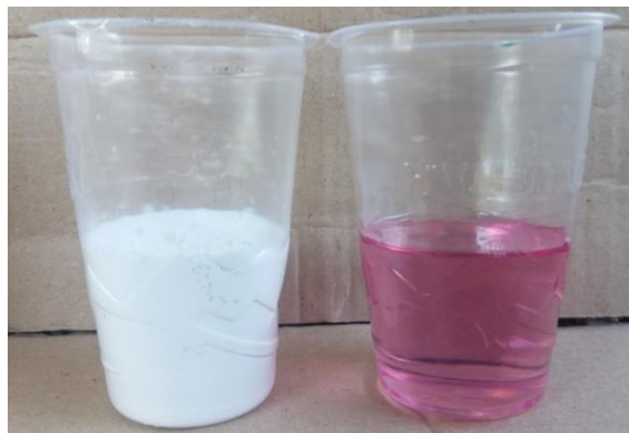
Gambar 4.4 Perbandingan 1:1 resin dan talk
