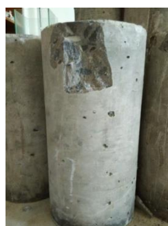
Gambar 4 Beton setelah uji tekan
