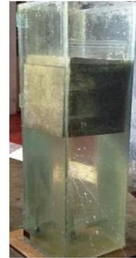
Gambar 4.14 Uji terapung beton
