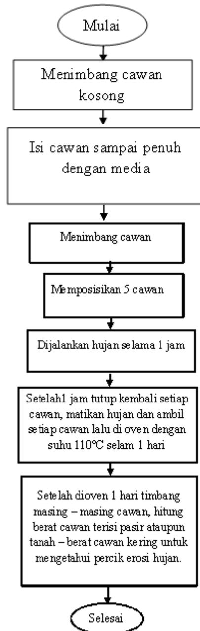
Gambar 4.5 Bagan alir pengujian percik erosi
