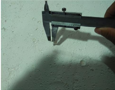
Gambar 5.1. Proses Pengukuran Diameter Butiran Hujan.
