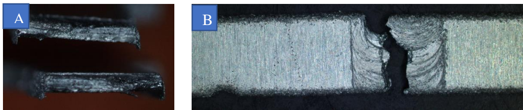
Gambar 4. 15 Perpatahan Specimen Sudut Kemiringan Tool 2^\circ ,(a) Tampak Depan Bagian patahan Las (b) Tampak Atas Bagian patahan Las
