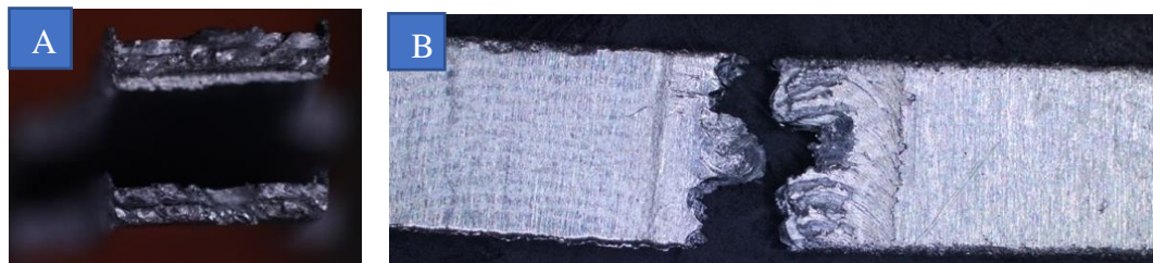
Gambar 4. 13 Perpatahan Specimen Sudut Kemiringan Tool 0^\circ ,(a) Tampak Depan Bagian patahan Las (b) Tampak Atas Bagian patahan Las
