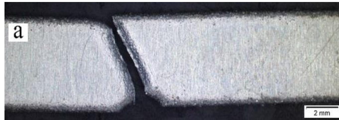
Tampak Depan Bagian Patahan Las (kiri) dan Tampak Atas bagian patahan Las (kanan)
