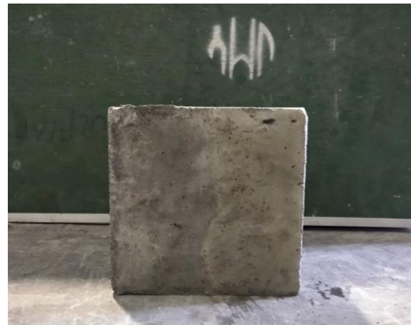
Gambar 5 (a) Beton cold joint arah horizontal dengan jeda waktu pengecoran 120 menit dan (b) beton cold joint arah vertikal dengan jeda waktu pengecoran 120 menit.
