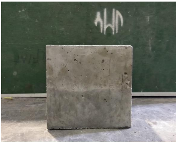
Gambar 5 (a) Beton cold joint arah horizontal dengan jeda waktu pengecoran 120 menit dan (b) beton cold joint arah vertikal dengan jeda waktu pengecoran 120 menit.
