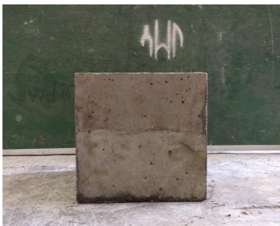
Gambar 6 (a) Beton cold joint arah horizontal dengan jeda waktu pengecoran 240 menit dan (b) beton cold joint arah vertikal dengan jeda waktu pengecoran 240 menit.
