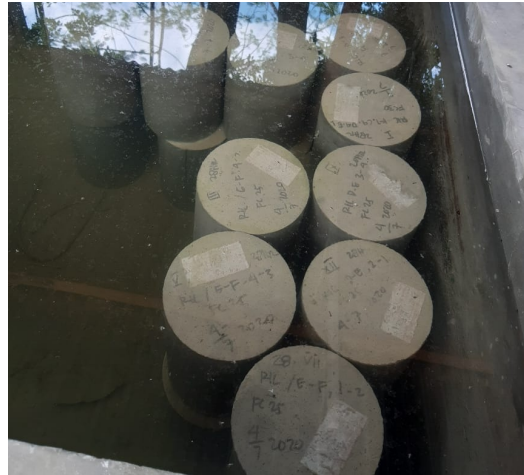
Gambar 3.18 Perawatan sampel beton.
