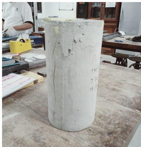
Gambar 4.2 Hasil retakan uji tekan sampel beton.
