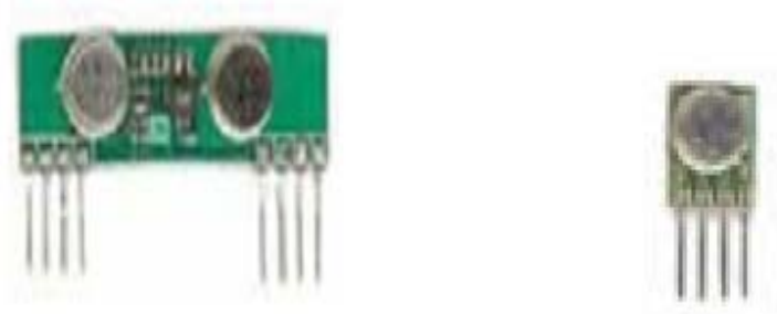
Gambar 1. modul radio RLP 433 dan TLP 433
