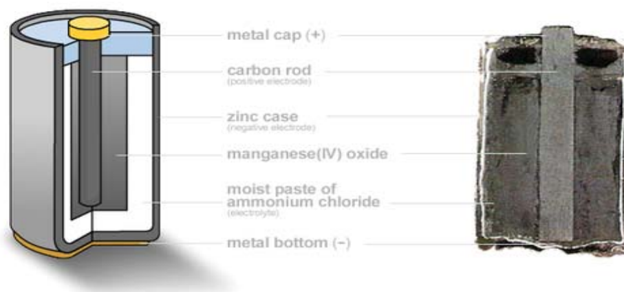
Gambar 13. struktur baterai
