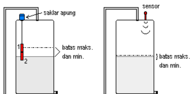
Gambar 1.3. Batas kondisi pengaturan kedua alat kendali
