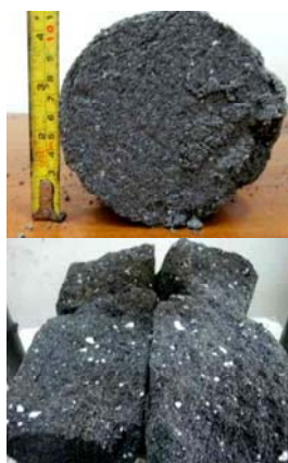
Gambar 9 Kondisi benda uji tanpa serat sebelum dan setelah setelah pengujian
