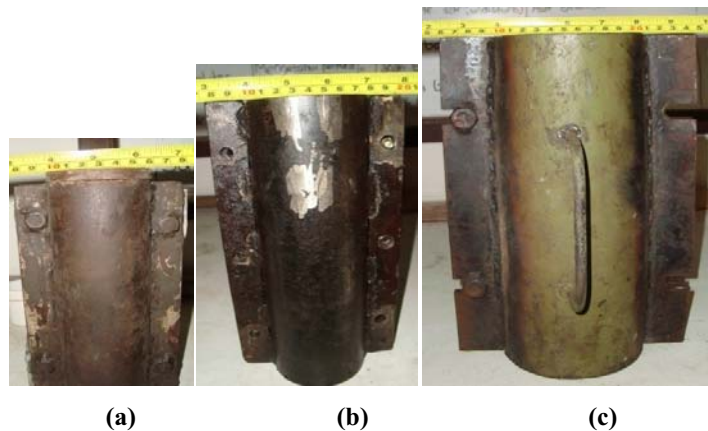
Gambar 5 Cetakan Silinder dari diameter 50 mm (a), 70 mm (b) dan (c) 110 mm
