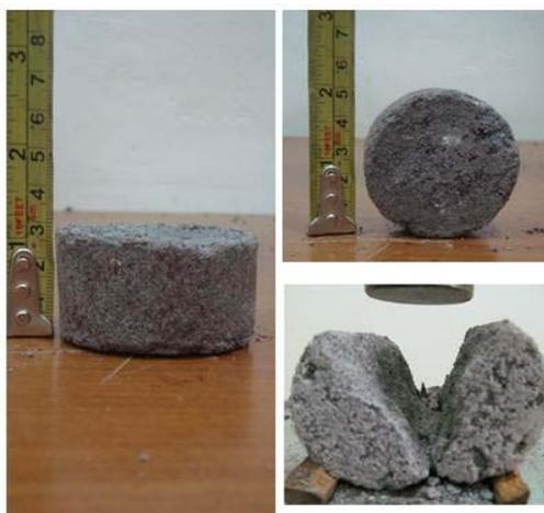
Gambar 6. Benda uji diameter 50 mm dengan rasio 0,5D sebelum diuji dan sesudah diuji
