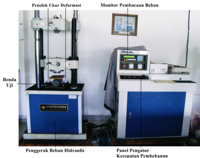
**Gambar 3. Pengujian dengan alat penekan berkapasitas 300 kN**
