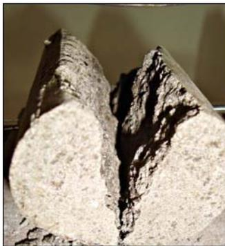
GAMBAR 7. Keretakan benda uji tanpa serat setelah diuji
