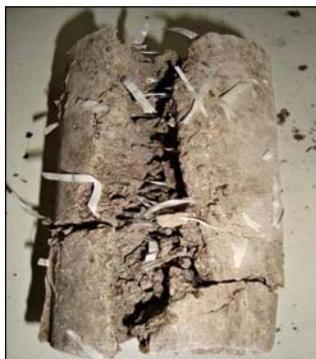
GAMBAR 8. Keretakan benda uji dengan serat setelah diuji
