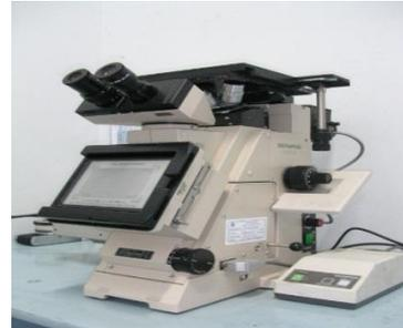
Gambar 3.2. Alat uji struktur mikro
