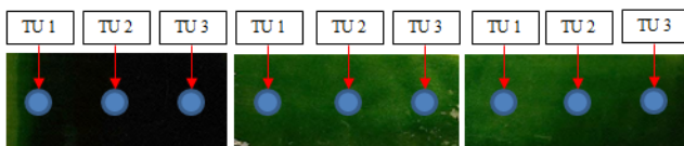
Gambar 4.2 Spesimen aluminium 1XXX setelah proses anodizing dan dyeing setelah dilakukan pengujian visual dengan adobe photoshop , (a) waktu celup 5 menit, (b) waktu celup 10 menit dan (c) waktu celup 15 menit. (TU) Titik Uji.
