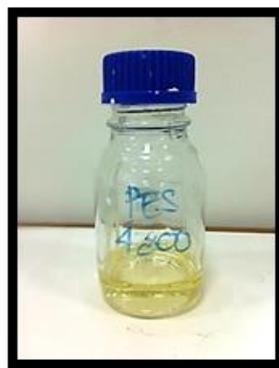
Gambar 1. Larutan Polyethersulfone
