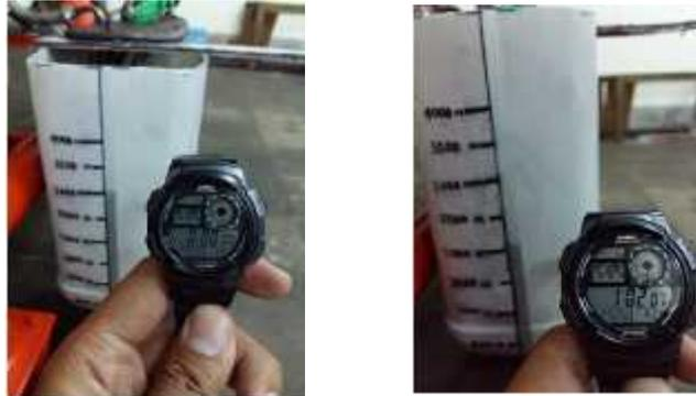
Gambar 4.3 Hasil pengujian konsumsi bahan bakar 1000 cc tanpa beban atau AC (*Air Conditioner*) tidak hidup sebelum di *overhaul* dan di *tune-up*
