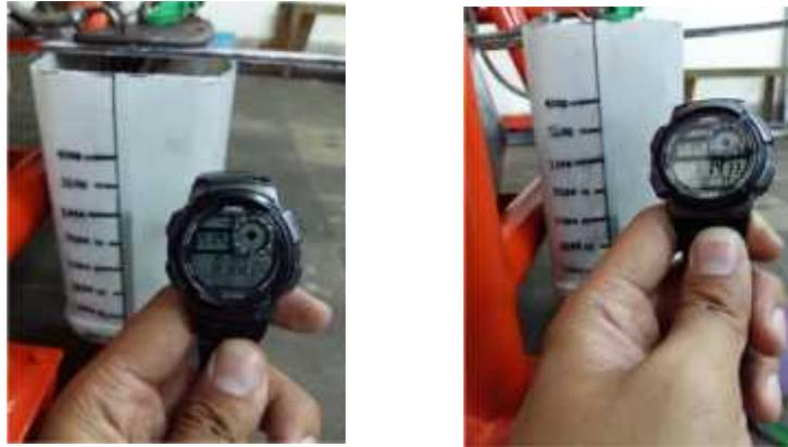
Gambar 4.58 Hasil pengujian konsumsi bahan bakar 1000 cc tanpa beban atau AC (*Air Conditioner*) tidak hidup setelah di *overhaul* dan di *tune-up*
