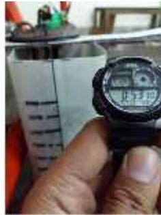
Gambar 4.5 Hasil pengujian konsumsi bahan bakar 1000 cc dengan beban atau AC(*Air Conditioner*) hidup sebelum di *overhaul* dan di *tune-up*
