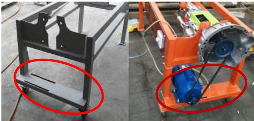
Gambar 4.9 Hasil Pembuatan Dudukan Motor Listrik
