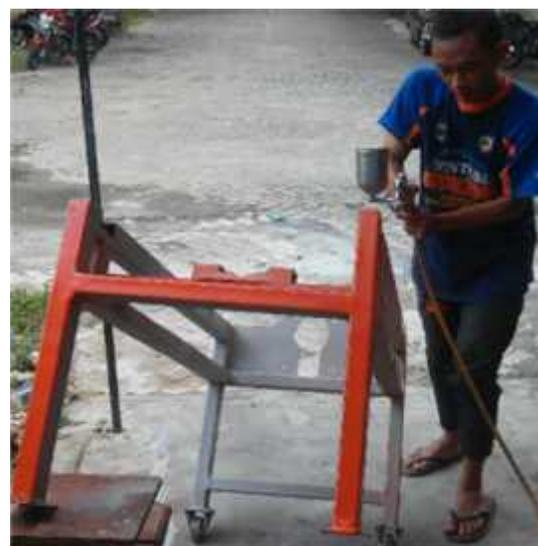
Gambar 4.13 Proses Pengecatan
