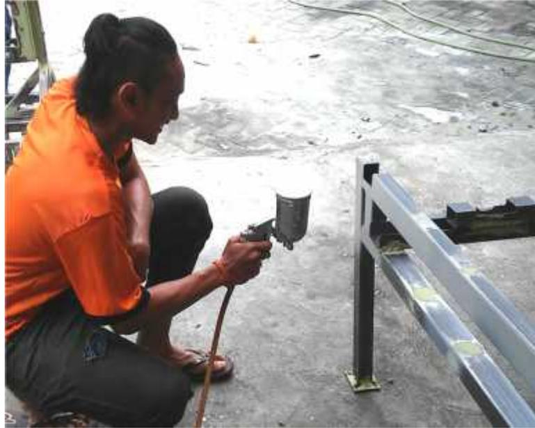
Gambar 4.11 Pelapisan Dasar Dengan Poxy
