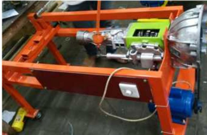
Gambar 4.16 Hasil Akhir Pembuatan Engine Stand
