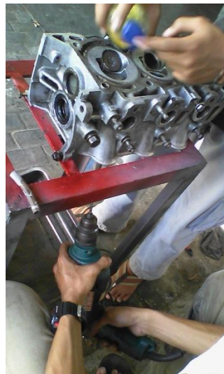
Gambar 5.30. Penyekuran Pada Katup
