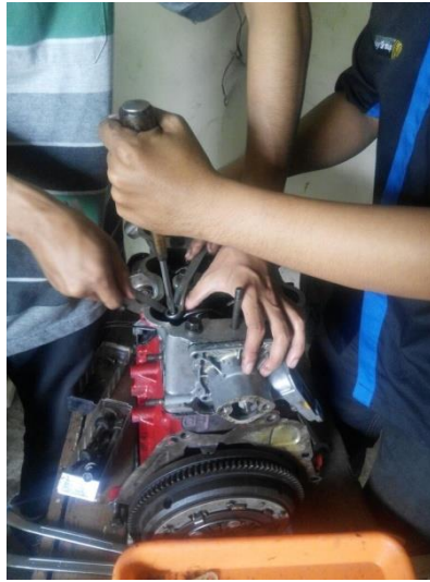
Gambar 5.31. Penyetelan Celah Pada Katup
