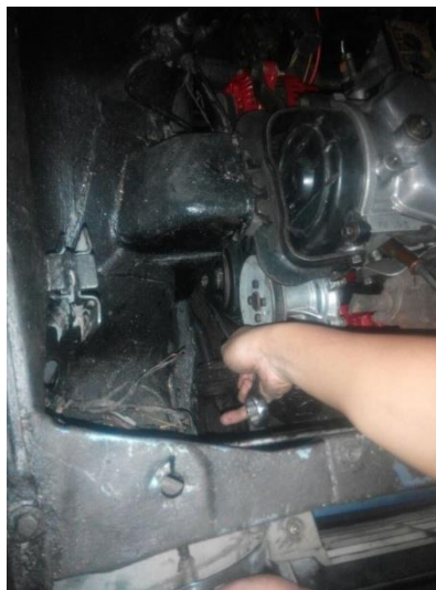
Gambar 5.4. Memutar Pully Memposisikan TOP Mesin
