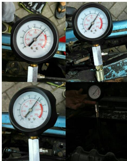
Gambar 5.2. Penegecekan Kompresi Sesudah Perbaikan
