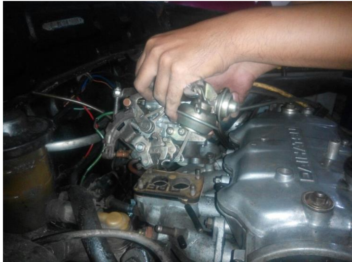
Gambar 5.13. Melepas Sistem Induksi Udara
