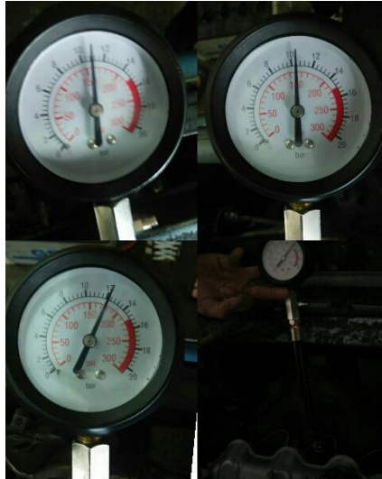
Gambar 5.1. Penegecekan Kompresi Sebelum Perbaikan
