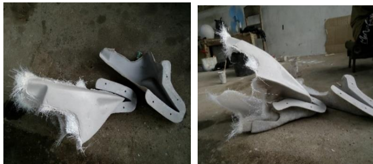
Gambar 4.19. pelepasan produk dari dalam cetakan
