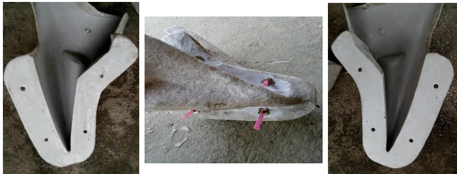
Gambar 4.12. pelubangan untuk pemberian baut
