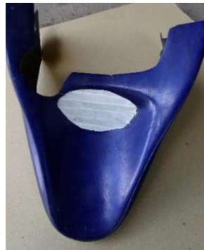
Gambar 4.4. fentilasi udara di tutup dengan isolasi kertas
