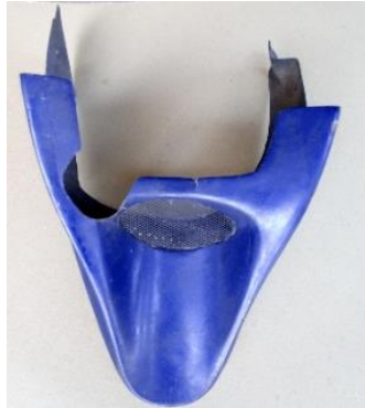
Gambar 4.1. master cetakan tutup mesin saat dijemur
