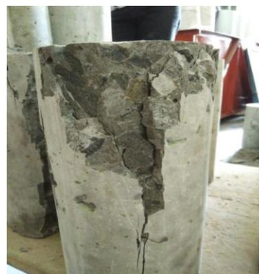
Gambar 5. Keruntuhan beton setelah pengujian kuat tekan
