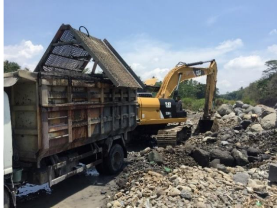
Gambar 4.2 Metode penambangan menggunakan bekhoe
