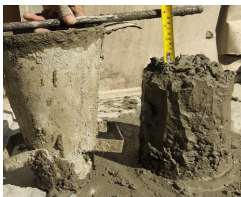
Gambar 4.1 Hasil slump test pada campuran beton
